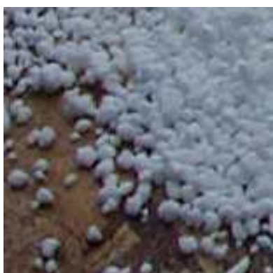
Het product, op basis van gerecycleerd glas, heeft de vorm van kleine korrels.
