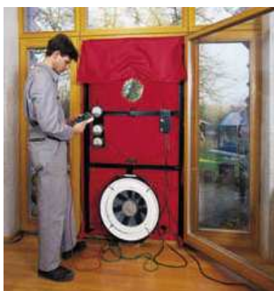
Controle van de luchtdichtheid met een BlowerDoor.
